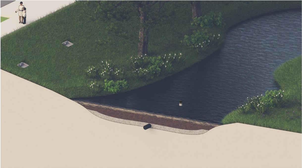
Figura 25- Representação esquemática de bacia de retenção com cobertura vegetalada.
