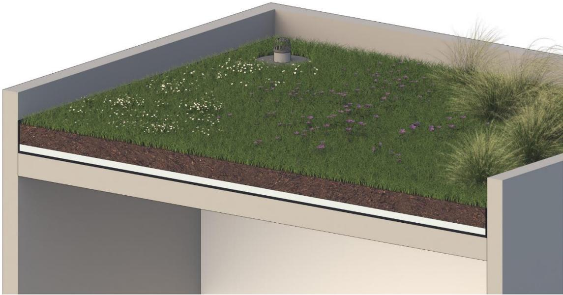
Figura 22- Representação esquemática de telhado verde extensivo.
