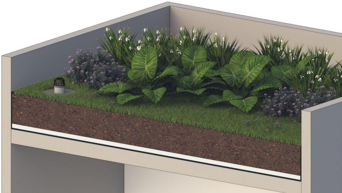
Figura 23- Representação esquemática de telhado verde intensivo.
