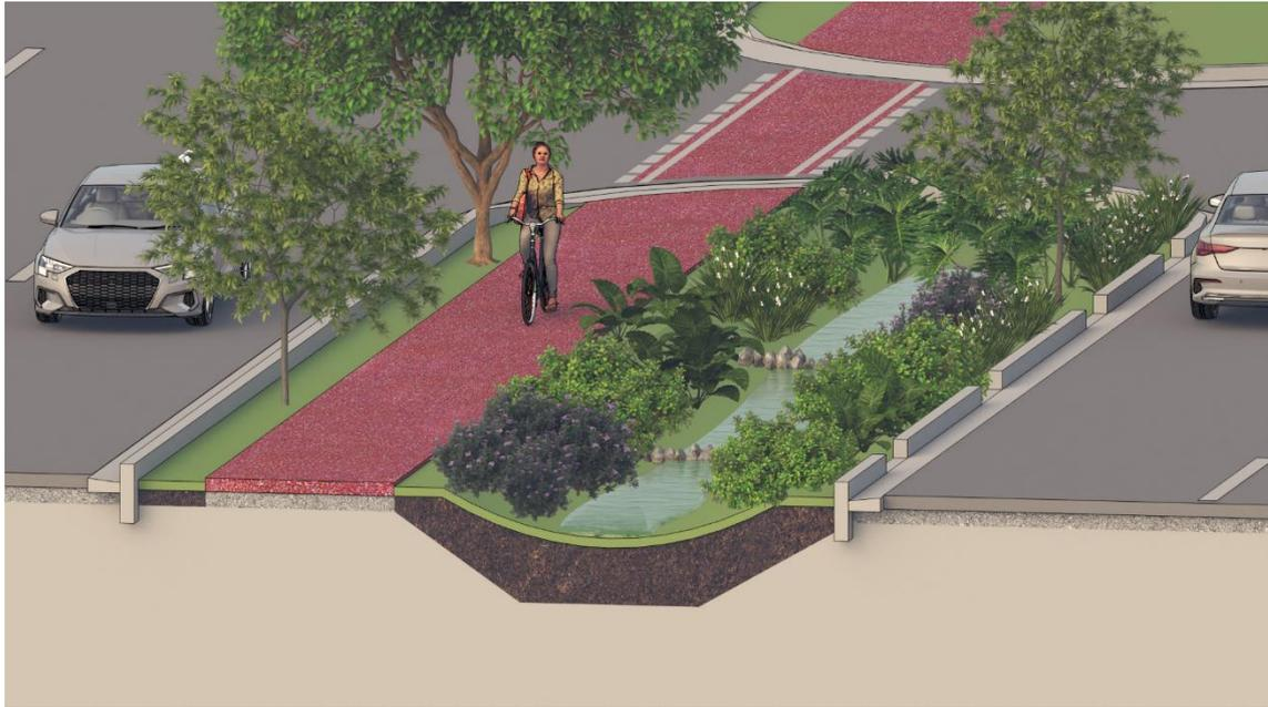
Figura 21 - Representação Esquemática de biovaleta.
