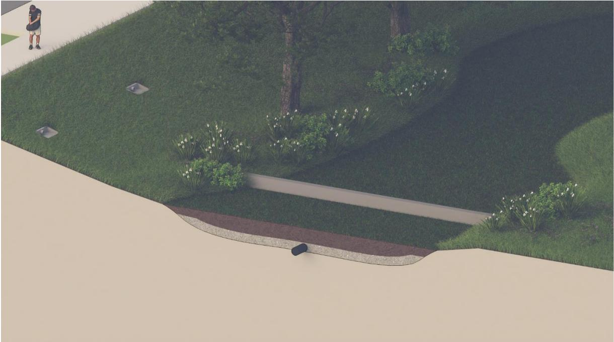
Figura 28 - Representação esquemática de retenção no lote aberto.
