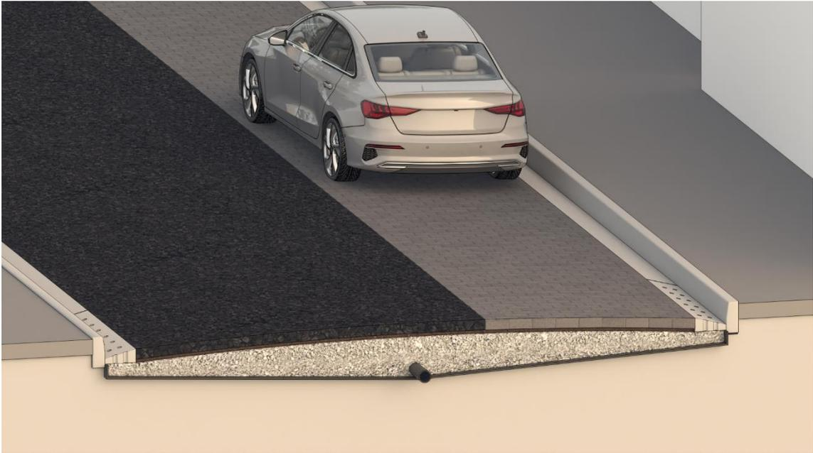
Figura 24- Representação esquemática de pavimento permeável do tipo asfalto poroso (via a esquerda) e bloco de concreto (via a direita).
