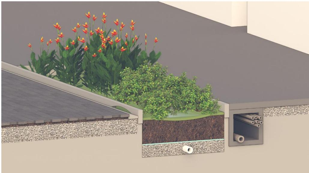
Figura 20 - Representação esquemática de jardim de chuva com sistema aberto.
