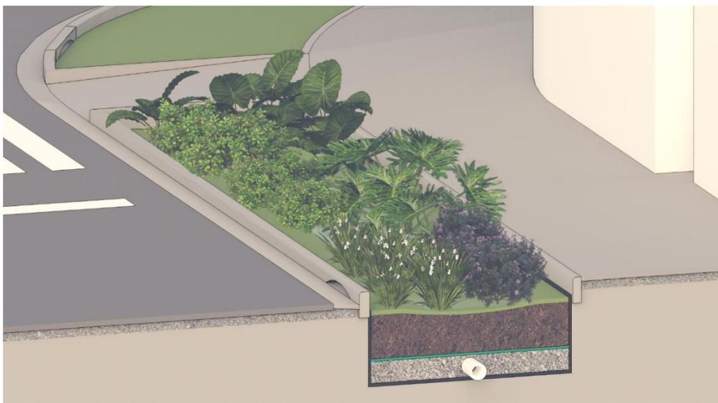
Figura 19 - Representação esquemática de jardim de chuva com sistema fechado.
