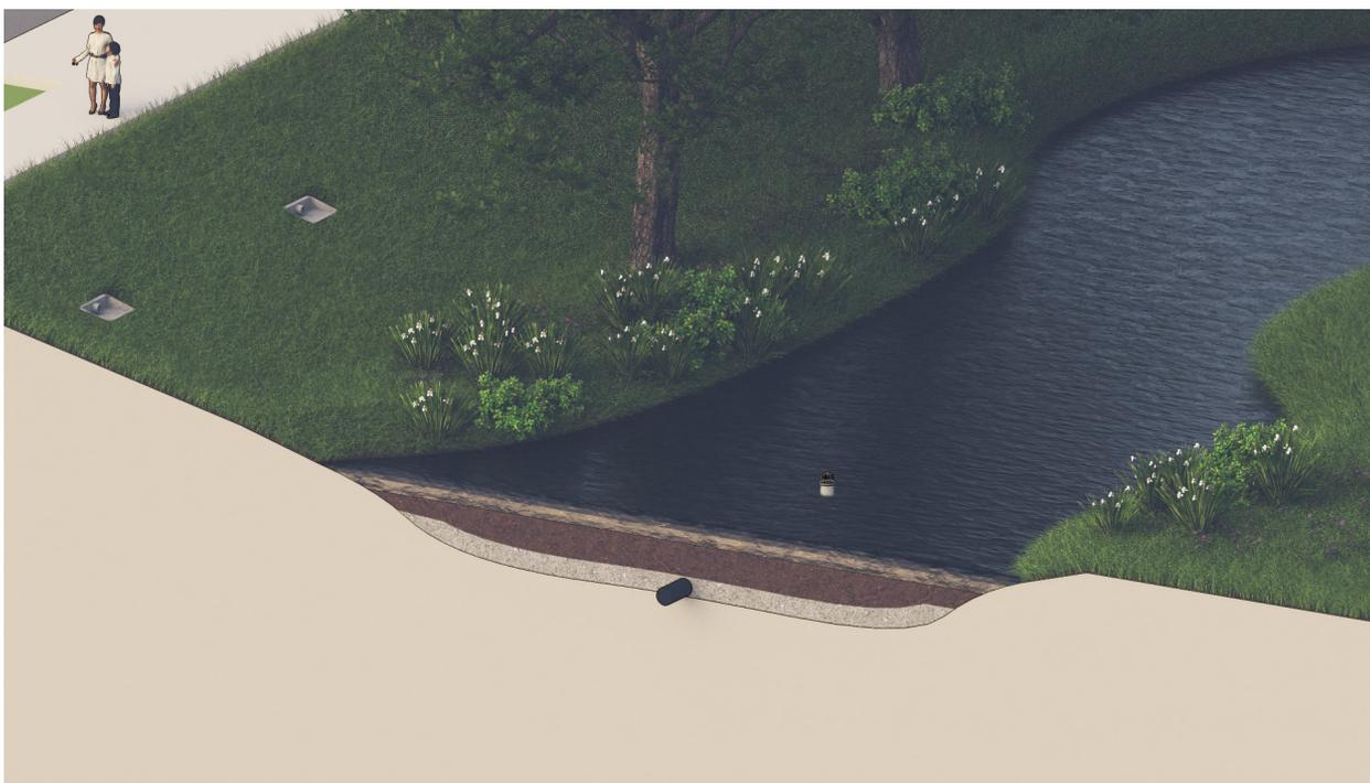
**FIGURA 15** Corte esquemático de bacia de detenção vegetada (FCTH, 2024)
