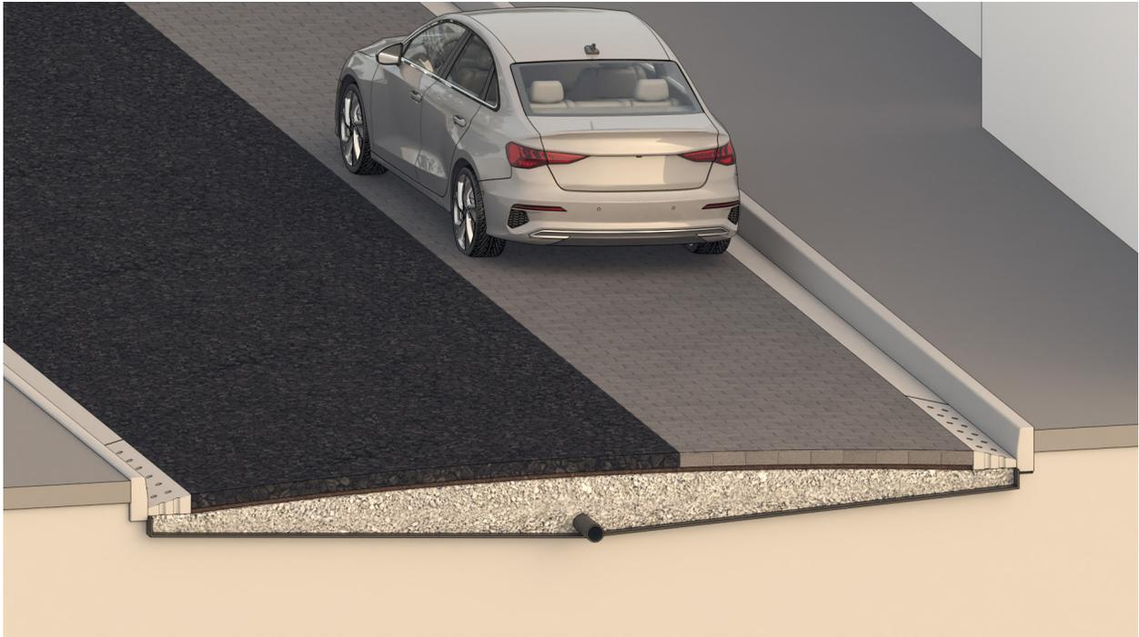
**FIGURA 14** Corte esquemático de pavimento permeável – bloco permeável com dreno integrado (FCTH, 2024)
