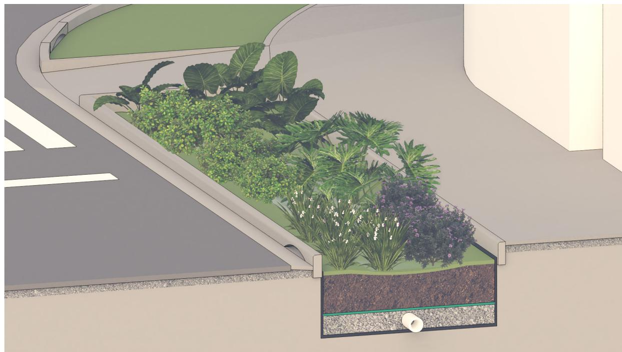
**FIGURA 11** Corte esquemático de biorretenção fechada (FCTH, 2024)
