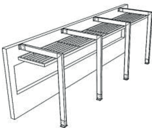
Figura 31. Sombreador externo horizontal com aletas.
