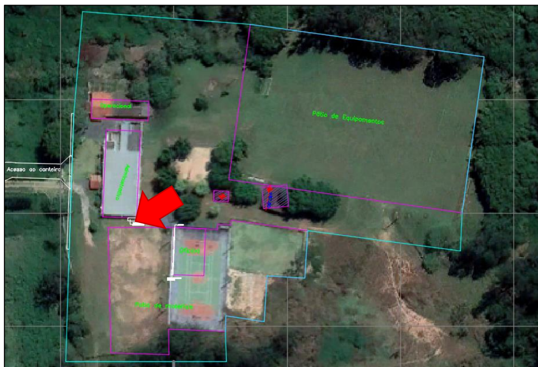
Figura 43 – Localização da área de acondicionamento dos resíduos sólidos em relação as instalações do canteiro de obras
