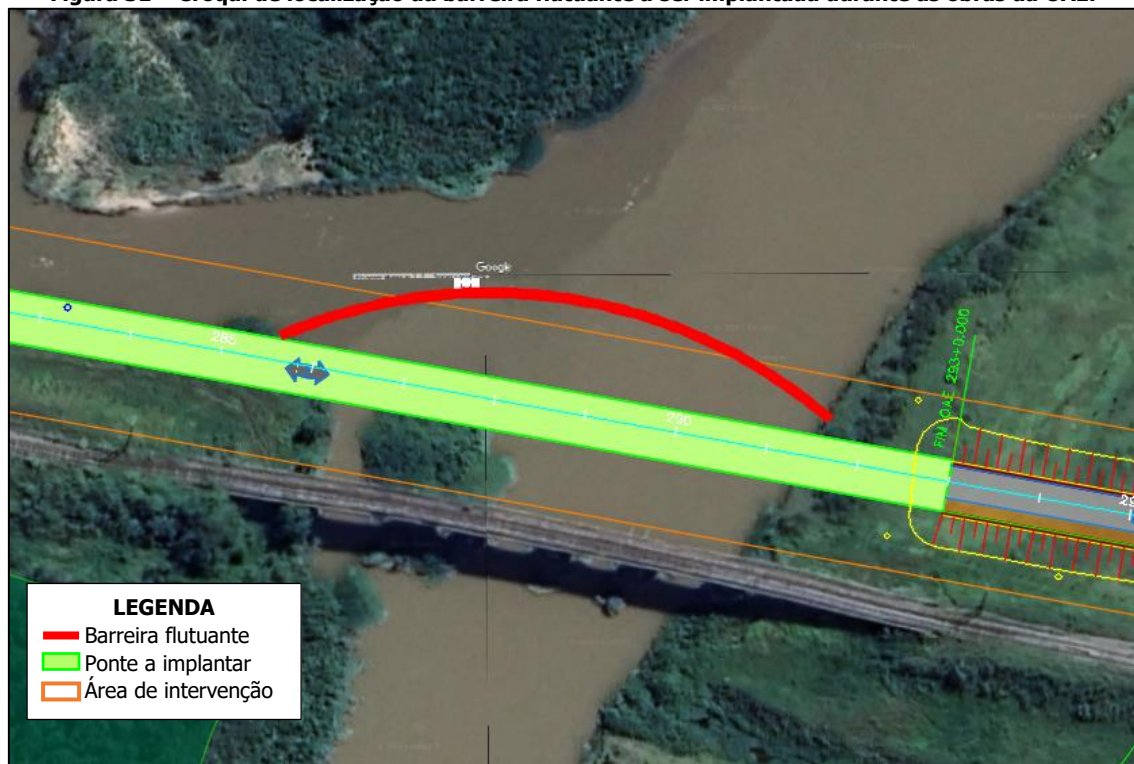
Figura 31 – Croqui de localização da barreira flutuante a ser implantada durante as obras da OAE.
