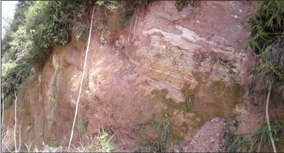
Foto 1 – Rocha alterada, composto de biotita gnaiss, com porções mais argilosas (alteração da biotita, mais rosadas) com porções mais arenosas (mais esbranquiçadas, alteração dos feldspatos e quartzo).
