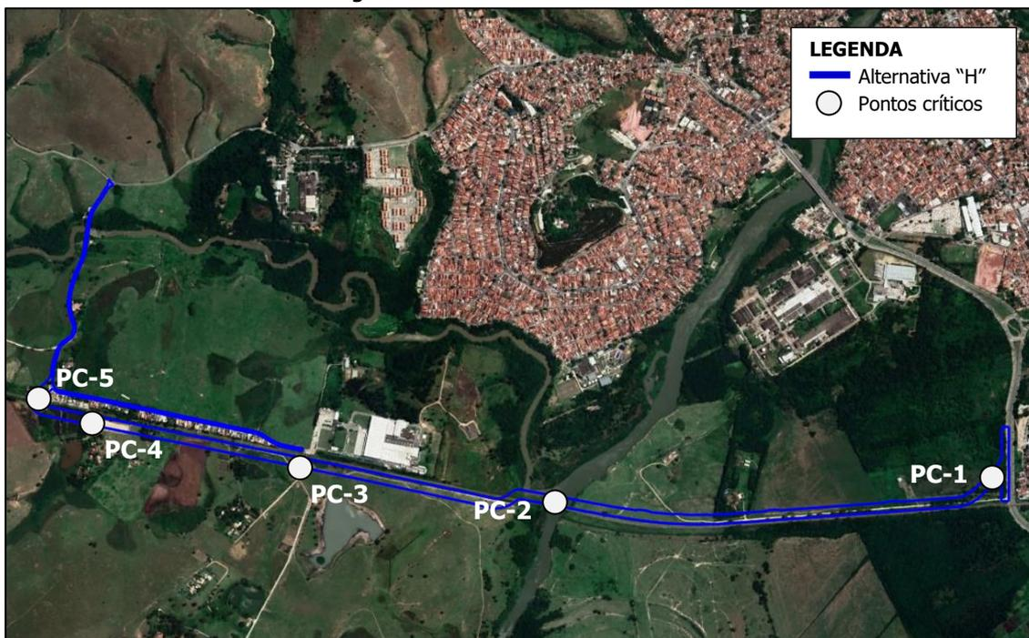
Para atender à solicitação de diminuição das perturbações nas áreas de várzea pela implantação do projeto, optou-se pela utilização das estradas pré-existent da localidade, que conforme apresentado nos subitens anteriores, reduzem o risco de instabilidade em decorrência do aterro já executado e também reduzem as novas intervenções em áreas de várzea.
