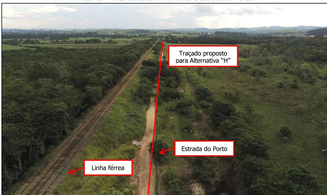
Ressalta-se que a utilização da Estrada do Porto diminui a terraplenagem, a supressão de vegetação e as novas intervenções nas áreas de várzea para implantação do empreendimento, utilizando terrenos previamente ocupados e/ou alterados.
