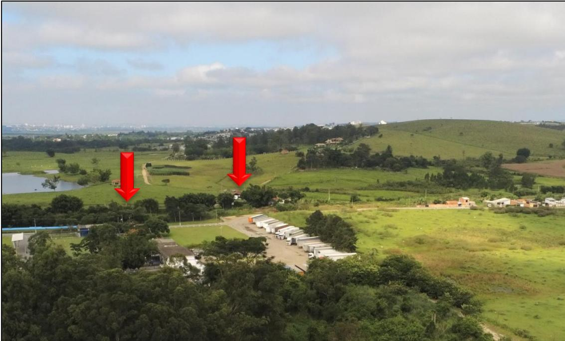
Seguindo a sul da ferrovia, o traçado deverá passar por uma área de lago de barramento inserido em propriedade particular, conforme mostra a Figura 72 e, conseqüentemente, intervir na Área de Preservação Permanente (APP) dos lagos, de aproximadamente 2.500,00 m<sup>2</sup>, caracterizando o **Ponto Crítico 4 (PC-4)**.
